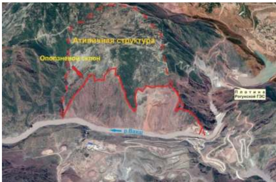
Рис.2. Оползневой склон с атипичной структурой в нижнем бьефе Рогунской ГЭС (Космоснимок из Google Earth от 7.07.2017 г.).
